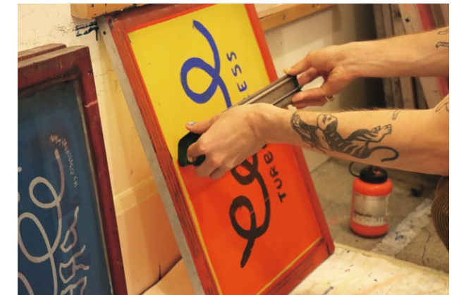
Le Lascaux Screen filler ferme le négatif du motif et le rend résistant à l'eau.
