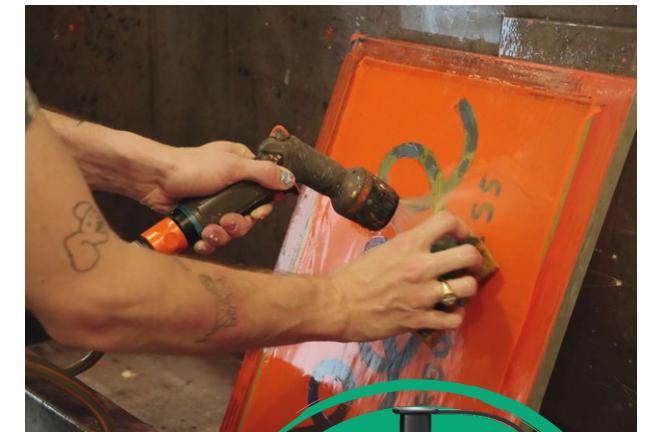
Le Screen painting fluid s'enlève par simple rinçage à l'eau chaude savonneuse – l'écran est alors prêt pour l'impression !
