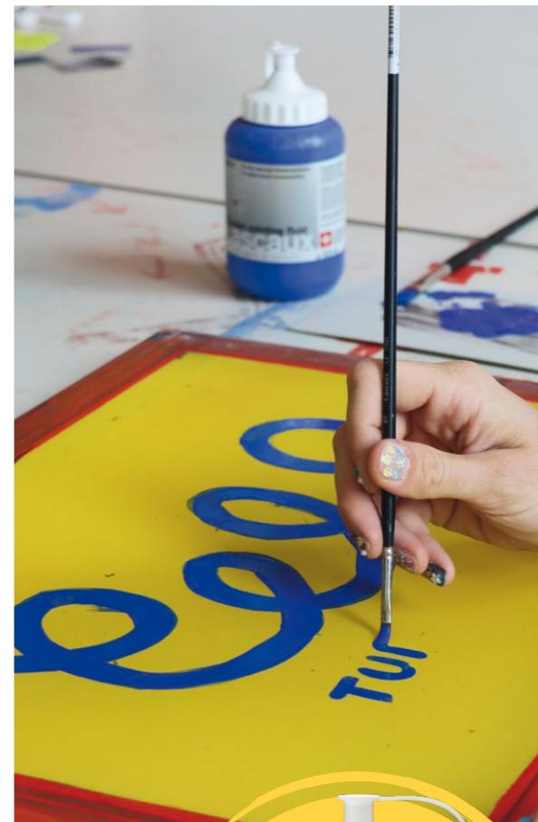
Mit Lascaux Screen painting fluid wird das Positiv des Motives temporär abgedeckt.
