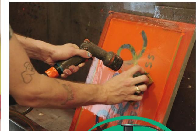
Mit warmem Seifenwasser wird das Screen painting fluid wieder ausgewaschen – das Sieb ist bereit zum Drucken!
