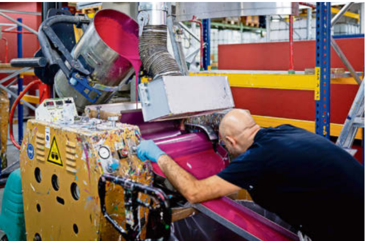
Abschliessend wird die Farbe in einer Maschine gewalzt. Das ist vergleichbar mit dem Conchieren bei der Herstellung von Schokolade.
